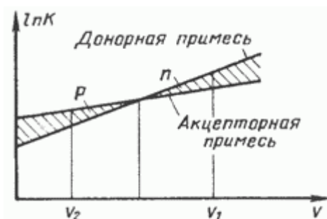
Рис. 6. Зависимость коэффициента распределения K донорной и акцепторной примесей от скорости вытягивания v
